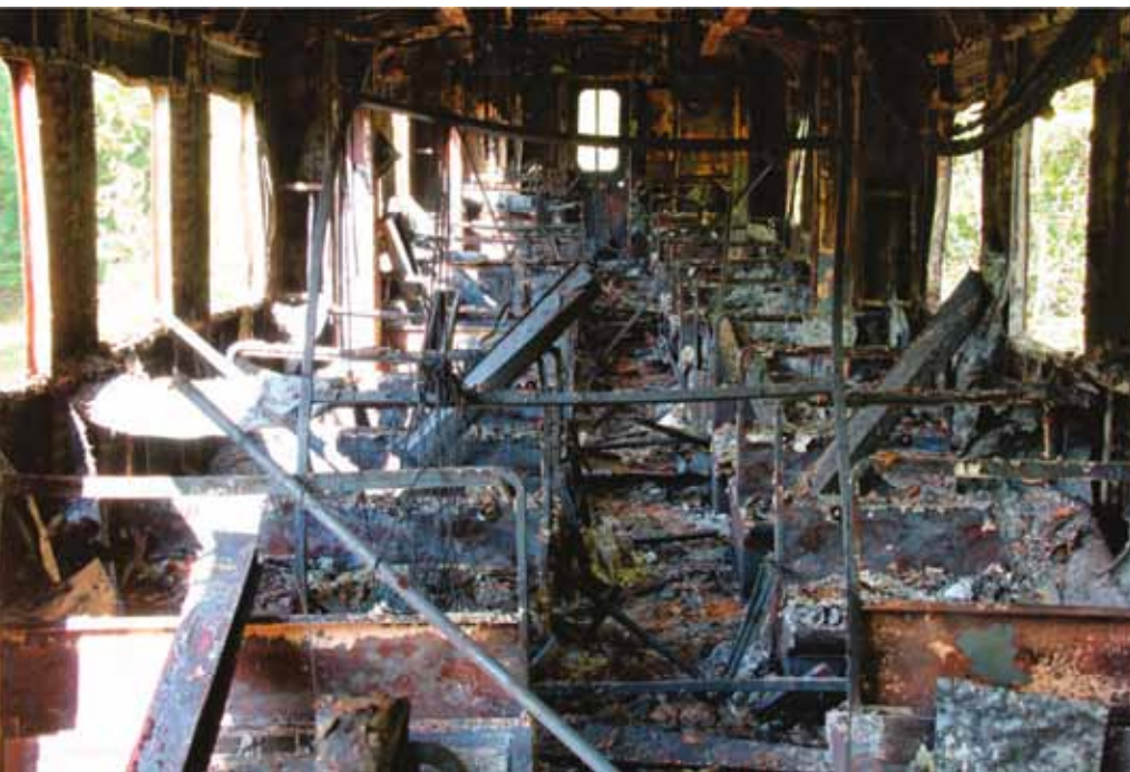
Abb. 6: Ein Versuchswaggon nach dem Test (Foto: Per Rohlén / METRO-Projekt)
