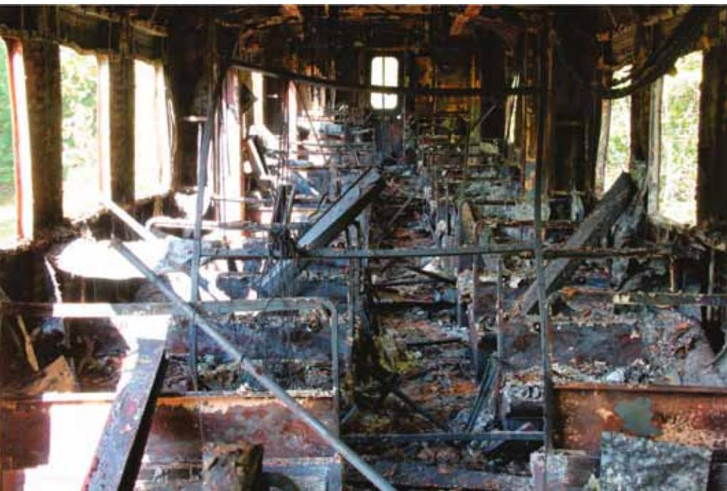
Abb. 6: Ein Versuchswagon nach dem Test (Foto: Per Rohlén / METRO-Projekt)
